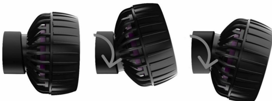
Rys. 2: kręcąc obudową pompy można zmienić kierunek wypływu. Prosimy upewnić się, że pompa jest skierowana kablem zasilającym do góry.
