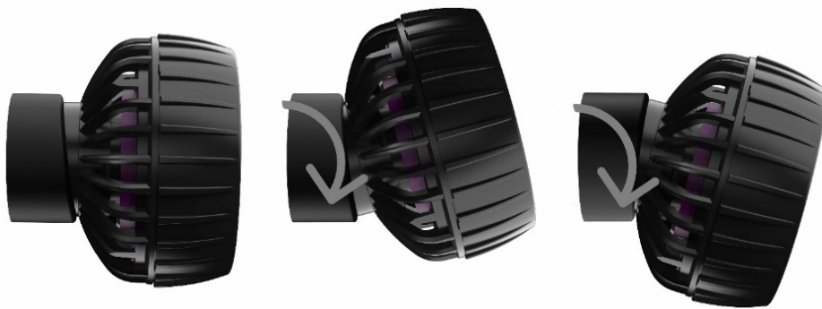
Рис. 2: Поворачивая магнит насоса, вы получаете разные направления потока. Убедитесь, что кабель насоса был направлен вверх.
