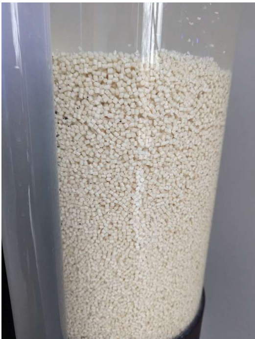
Abb. 2: Befüllter Pellet Filter in Betrieb. Die Pellets werden nur leicht aufgewirbelt.
