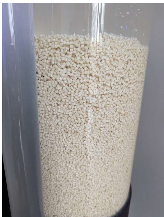
Fig. 2: Filtro a pellet pieno in funzione. I pellet vengono fatti girare solo leggermente.
