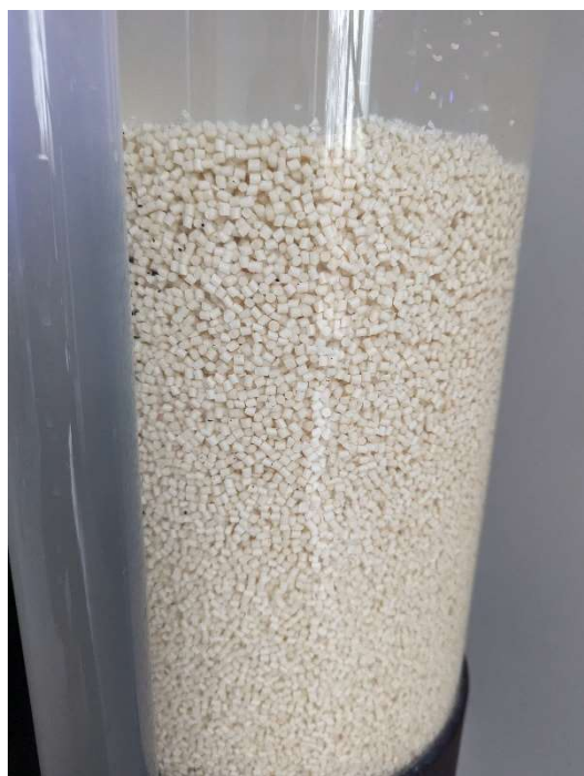
Fig. 2: Pellet Filter rempli en fonctionnement. Les pellets ne tourbillonnent que légèrement.
