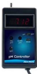
Appareil de mesure et de réglage du pH
